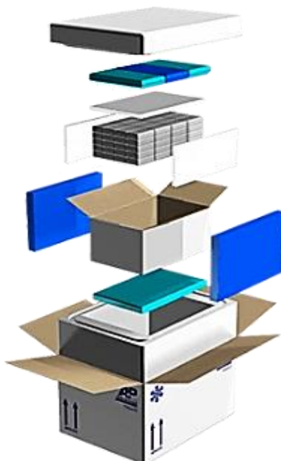
Ilustración No. 8. Empaque y embalaje de biológicos que requieren condiciones de ultracongelación, Bodega Zona Franca, Ministerio de Salud y Protección Social.
